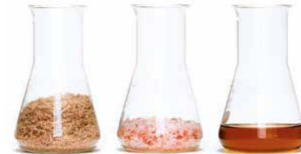
Matières premières utilisées : Environ 60% de cosses de riz, 22% de sel gemme, 18% d'huile minérale.
